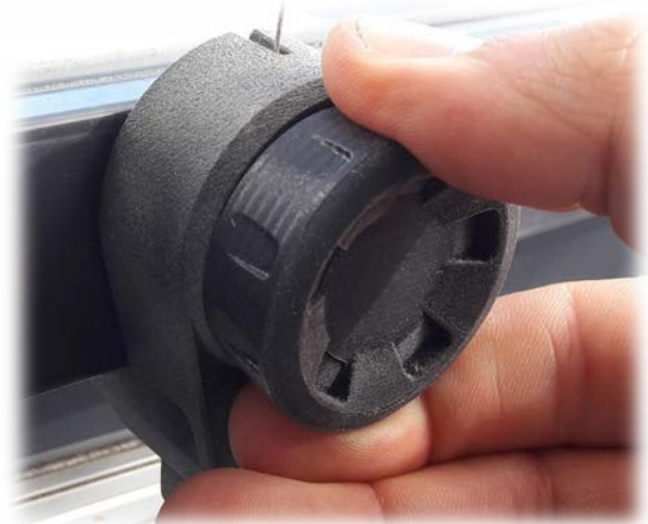
Kuva 2. Nupin alapuolella oleva lapsilukko vapautetaan painamalla etusormella
